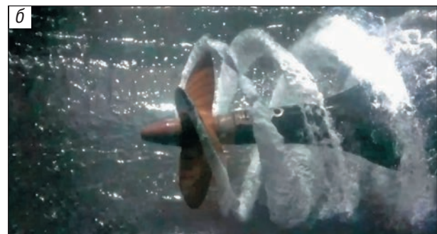
Рис.1. Различные стадии кавитации на гребных винтах: начальная ( а ) и развитая ( б ). Сначала формируется небольшая каверна на кромке лопасти гребного винта, а также возникает кавитация концевой вихря лопасти ( а ). Развитая кавитация засасывающей поверхности лопасти гребного винта выражается в развитии больших каверн, захватывающих большую часть поверхности лопасти. Сходящая вихревая пелена содержит значительное число паровых пузырей ( б ).
